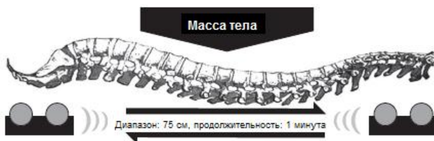
РИСУНОК 2. Схематическое представление автоматического хиропрактического массажера. Пара валиков массирует мышцы вдоль позвоночника, двигаясь вверх-вниз от шейных позвонков до копчиковых позвонков.
