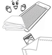
Не кладите пульт управления под одеяло во время использования изделия (это может стать причиной поломки или возникновения пожара). Используйте турманиевый мат, накрыв его полностью одеялом для предотвращения сосредоточения тепла в одном месте.
